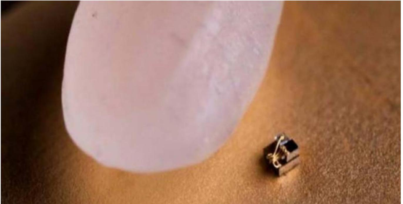
El tamaño de la nueva invención informática es muy reducido para tener antenas de radio convencionales, por lo que posee procesadores, transmisores y receptores inalámbricos, mediante los cuales recibe y transmite datos con luz visible.
