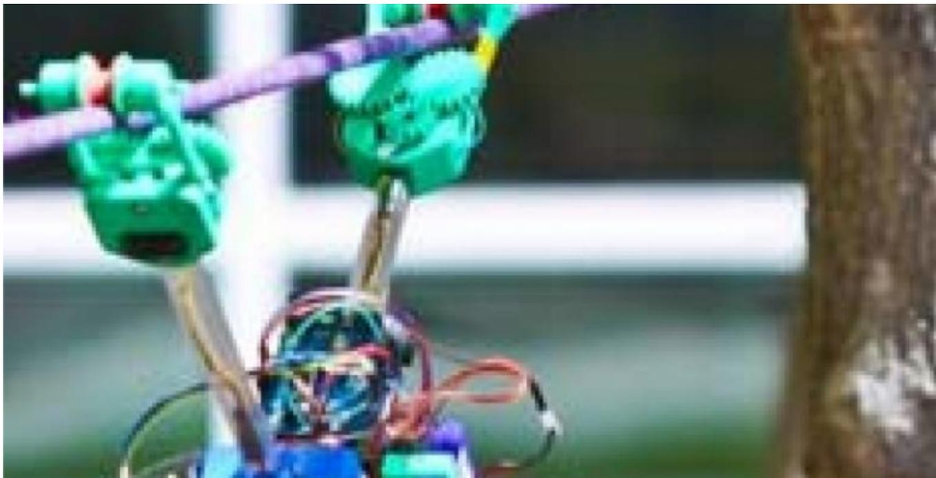
Un equipo de ingenieros desarrollaron un nuevo robot que inspecciona de manera directa líneas eléctricas de alta tensión. El denominado SkySweeper está equipado con codos motorizados y pinzas que le permiten asirse a los cables y avanzar por ellos.
